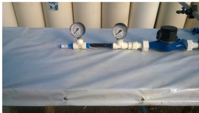
Figura 3. Determinação da perda de carga no conector Cipla®.
